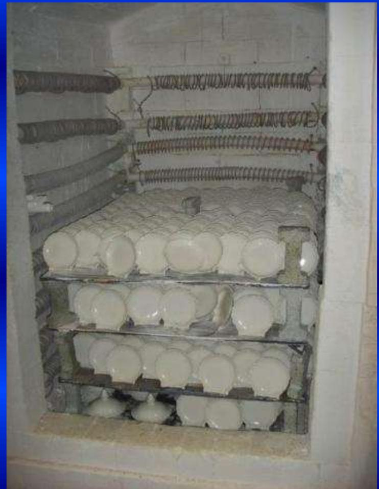
Затем в гипсовые формы заливают шликер (жидкую фарфоровую массу). Пористый гипс впитывает влагу, шликер постепенно затвердевает и приобретает очертания формы изделия. Формы вынимают и обжигают в муфельных печах.
