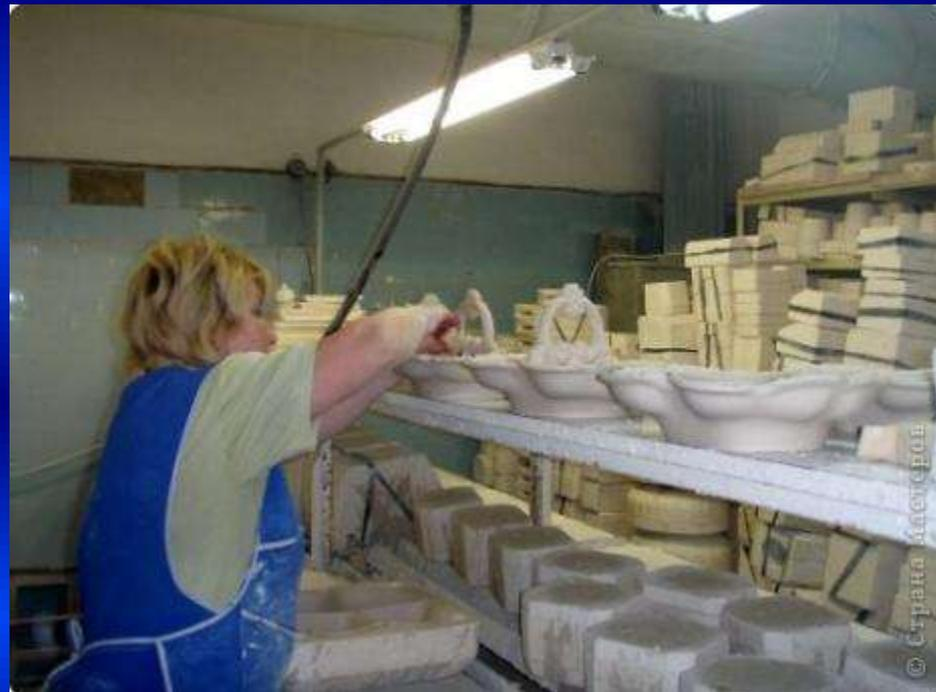
Технология изготовления гжельской керамики на первый взгляд покажется проста, но она требует определенных физических затрат. Сначала на специальных станках создают гипсовые модели будущих изделий.
